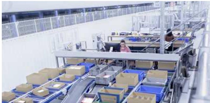
Advanced Pick Station one-level: Kommissionierung von bis zu vier Aufträgen gleichzeitig
