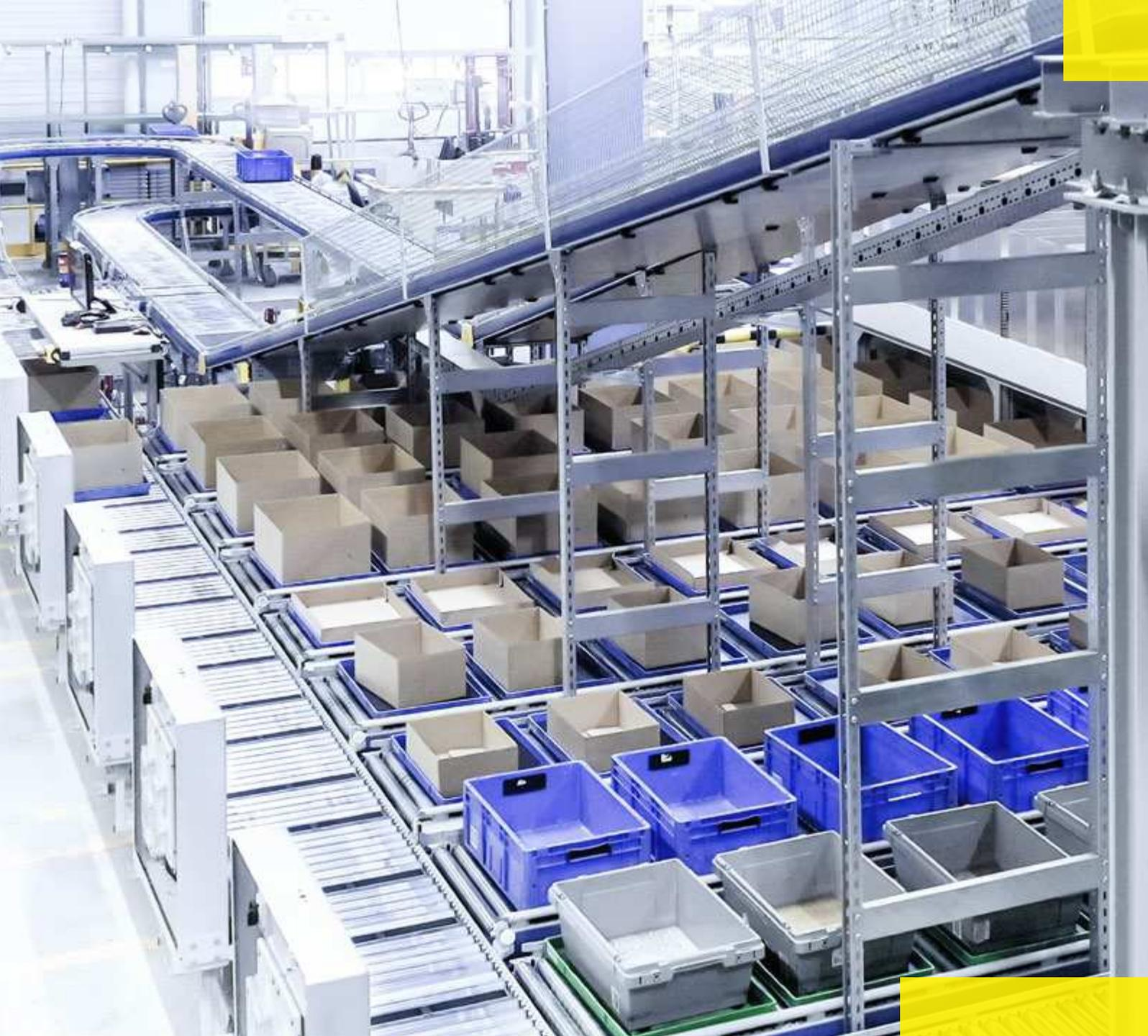
Vollautomatisches Abziehen von Auftragsbehältern oder -kartons im Auftragsstart
