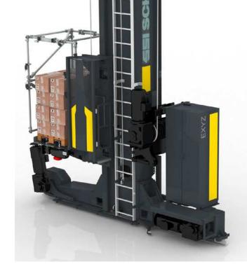
SSI Exyz überzeugt durch höchste Flexibilität: So kann unser Regalbediengerät als Einmaster oder Zweimaster mit einem oder zwei Lastaufnahmemitteln für eine einfach-, doppel- oder mehrfachtiefe Ein- und Auslagerung inklusive SSI Orbiter LHD eingesetzt werden. Die Konfiguration der RBG erfolgt nach einem effizienten Baukastenprinzip: Die SSI Exyz-Komponenten werden in Serie gefertigt, im Werk vormontiert und können somit innerhalb kürzester Zeit in Betrieb genommen werden.
