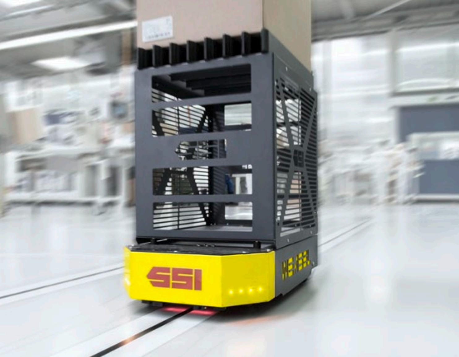
zu 1 m/s entlang einer optischen Fahrspur, die einfach, schnell und flexibel aufgebracht werden kann.
