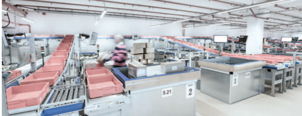
Manuelles Scannen und Umpacken von den Paletten auf Trays und in Behälter
