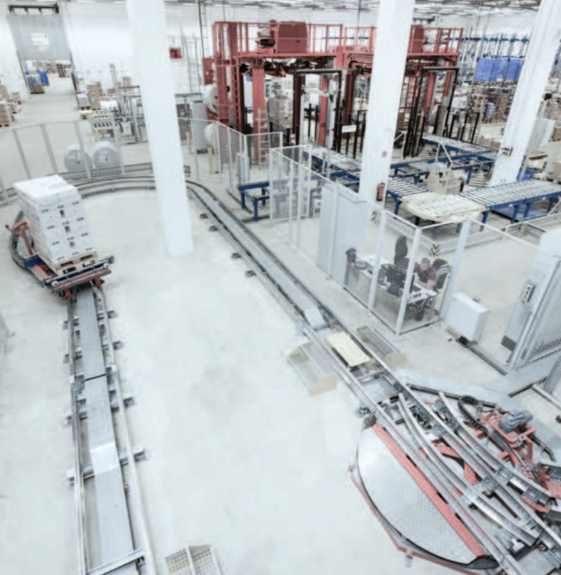
Transport zwischen den Bedarfsstellen durch die Elektrobodenbahn
