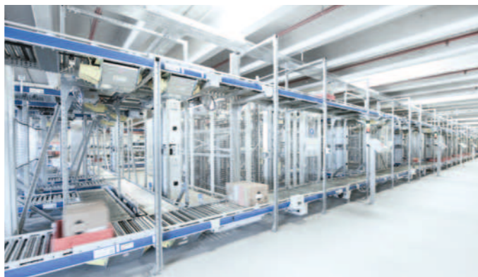
Verbindende Fördertechnik des AKLs vom Wareneingang zu den Kommissionier- und Versandplätzen
