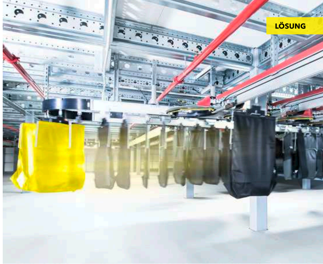
Sortierung der Taschen im Matrix-Sorter und Erzeugung der Kundenaufträge in geordneter Sequenz
