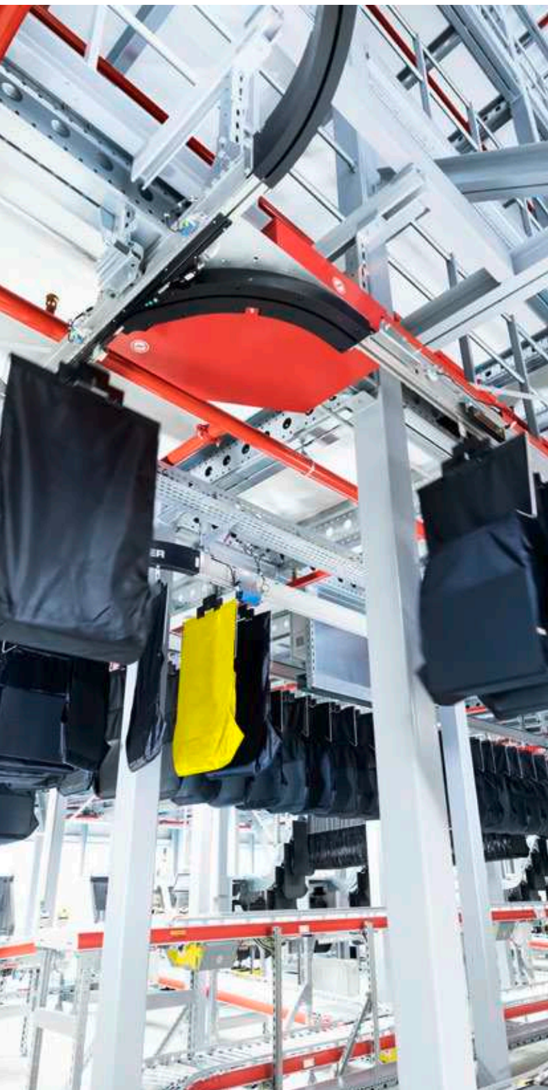
Optimale Raumnutzung durch hängenden Transport der Produkte
