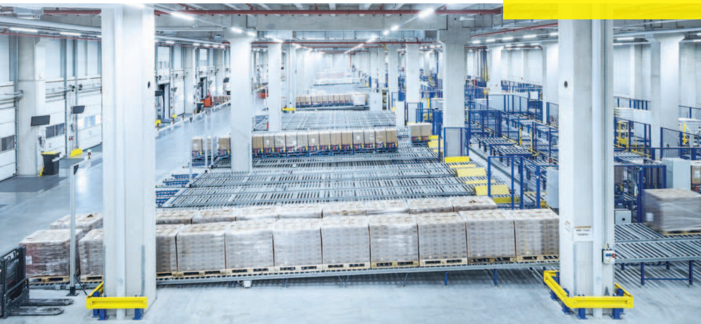
Durch einen vollautomatischen Warenausgangspuffer werden Wartezeiten vermieden
