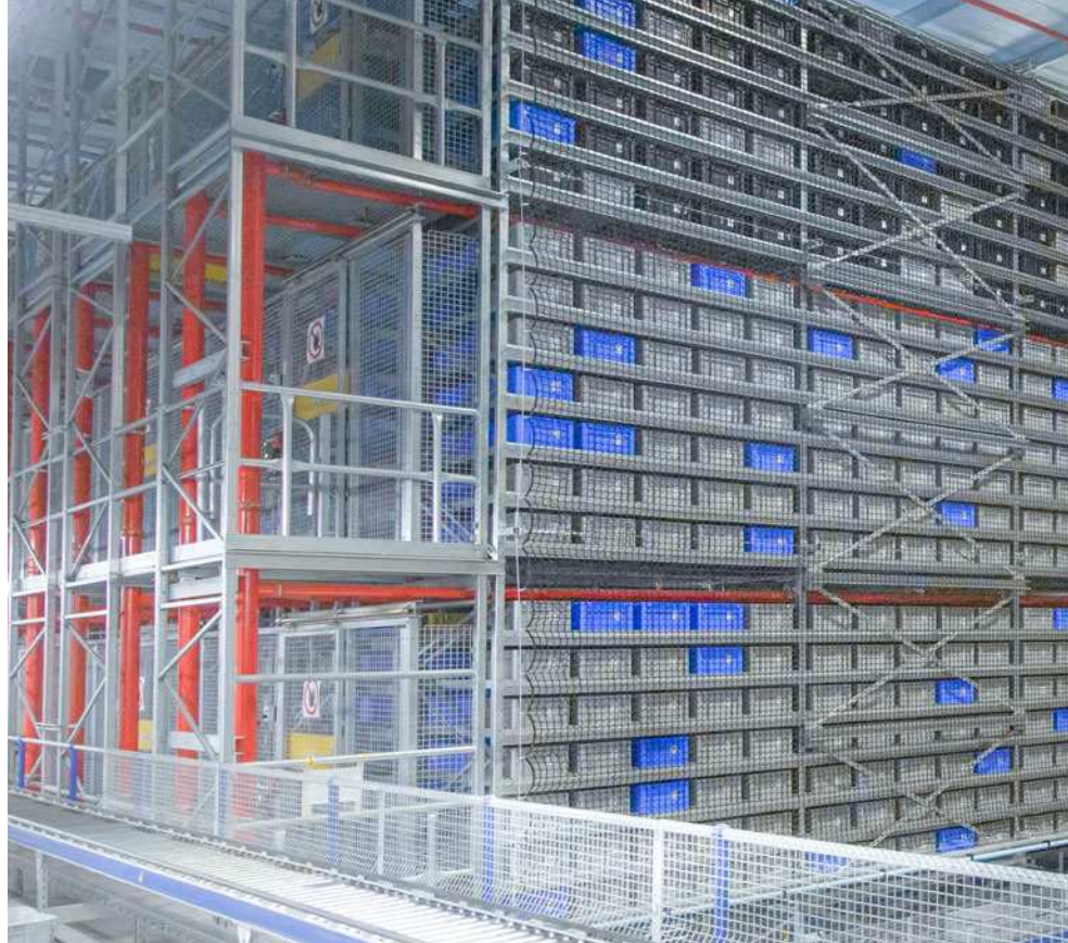
SSI Cuby Shuttle-System mit patentiertem 3D-MATRIX Konzept
