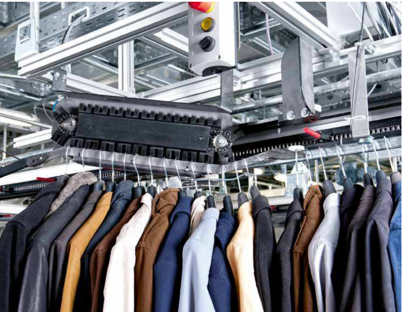
▼ Trolleyentladung durch Kombination von Lamellen-, Finger- und Klinkenförderer
