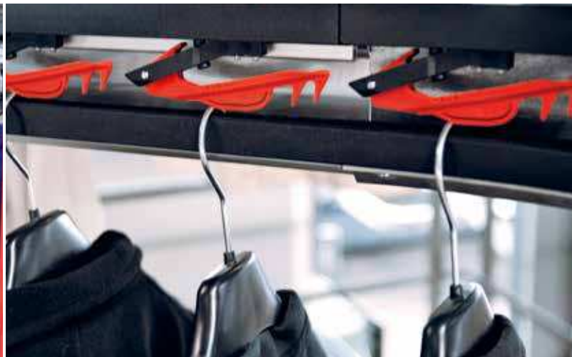
▼ Klinkenförderer – Transport bei geschlossener Klinke
