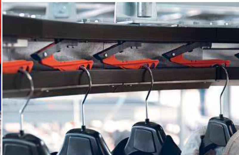
▼ Klinkenförderer – Transport bei geschlossener Klinke
