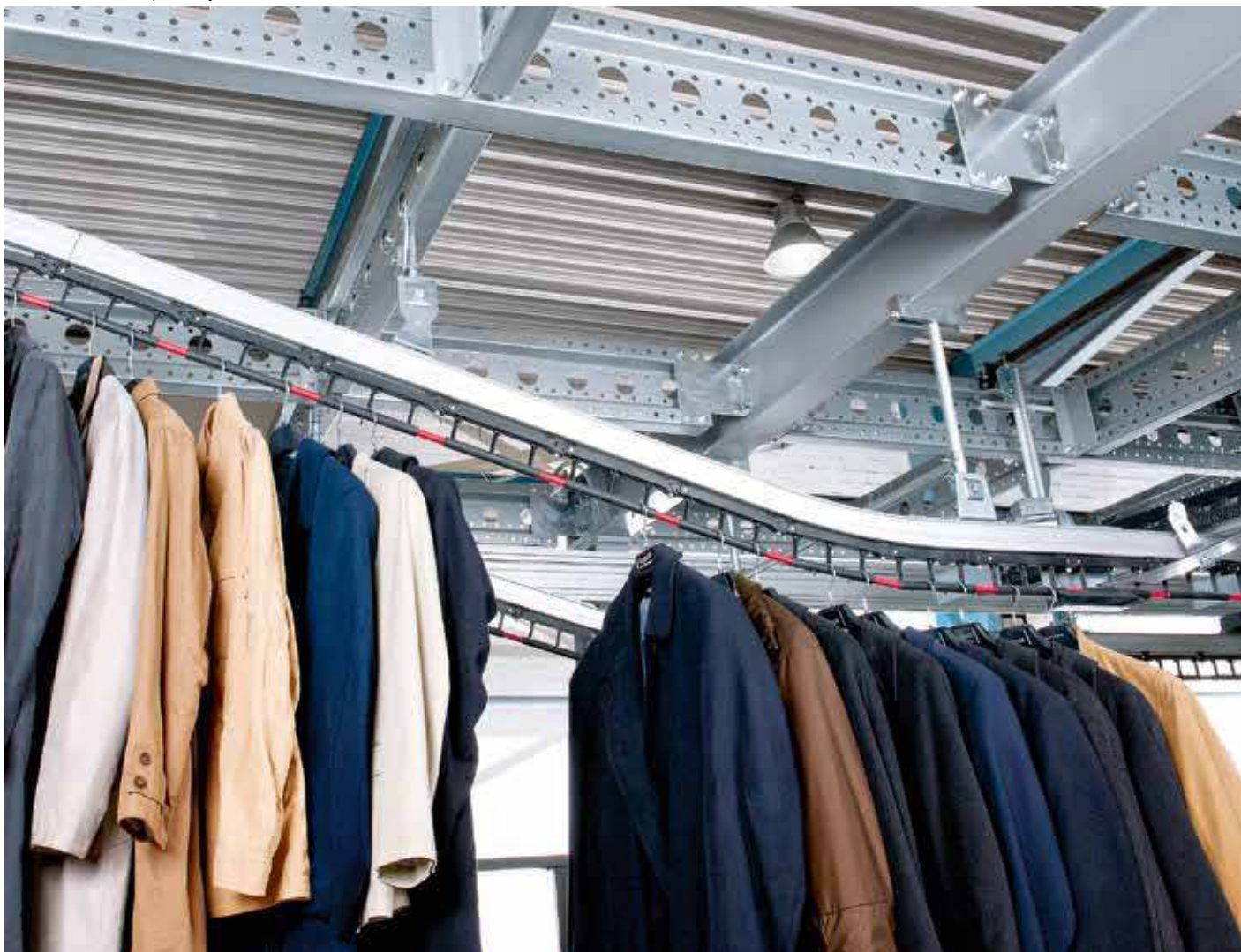
▼ Leiterförderer als Speichersystem
