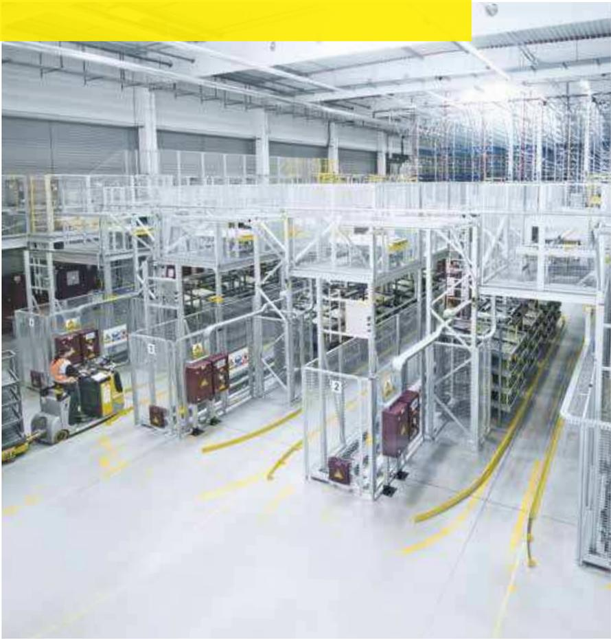
„Minimales manuelles Handling, direkte, optimierte Materialbereitstellung, reduzierter Personalaufwand und verbesserte Ergonomie. Mit der Anlagenautomation, der Materialflussumstellung und der durchgängigen SAP-Lösung haben wir die Abläufe vereinfacht und gestrafft, die Prozesse transparenter gestaltet und den Durchsatz gesteigert. Eine intelligente Lösung für eine vollautomatisierte Produktionsversorgung, mit der wir sehr zufrieden sind.“
