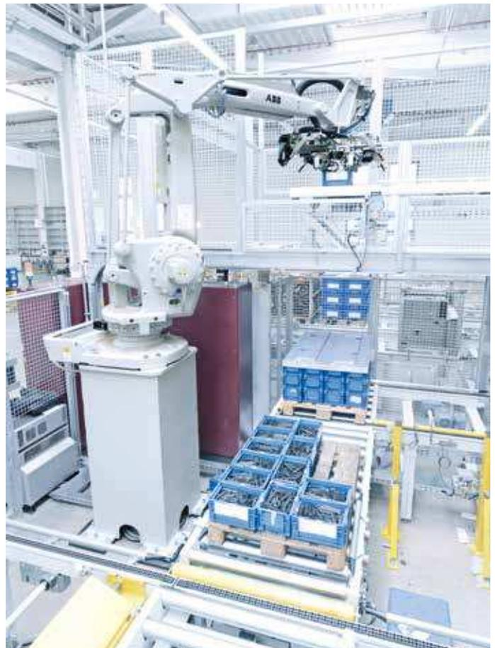
Für das Umsetzen ist der Roboter mit einem speziellen Greiffingersystem ausgestattet
