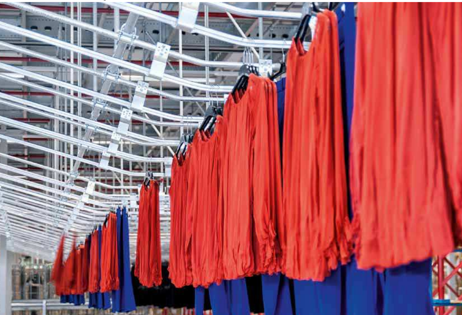
▼ Sorter-Abwurfstangen im Gefälle
