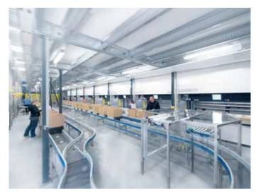
Plusieurs LOGIMATs peuvent être utilisés pour la préparation des commandes et le stockage des articles. La liaison aux autres zones de stockage peut être assurée par le SSI Autocruiser.
