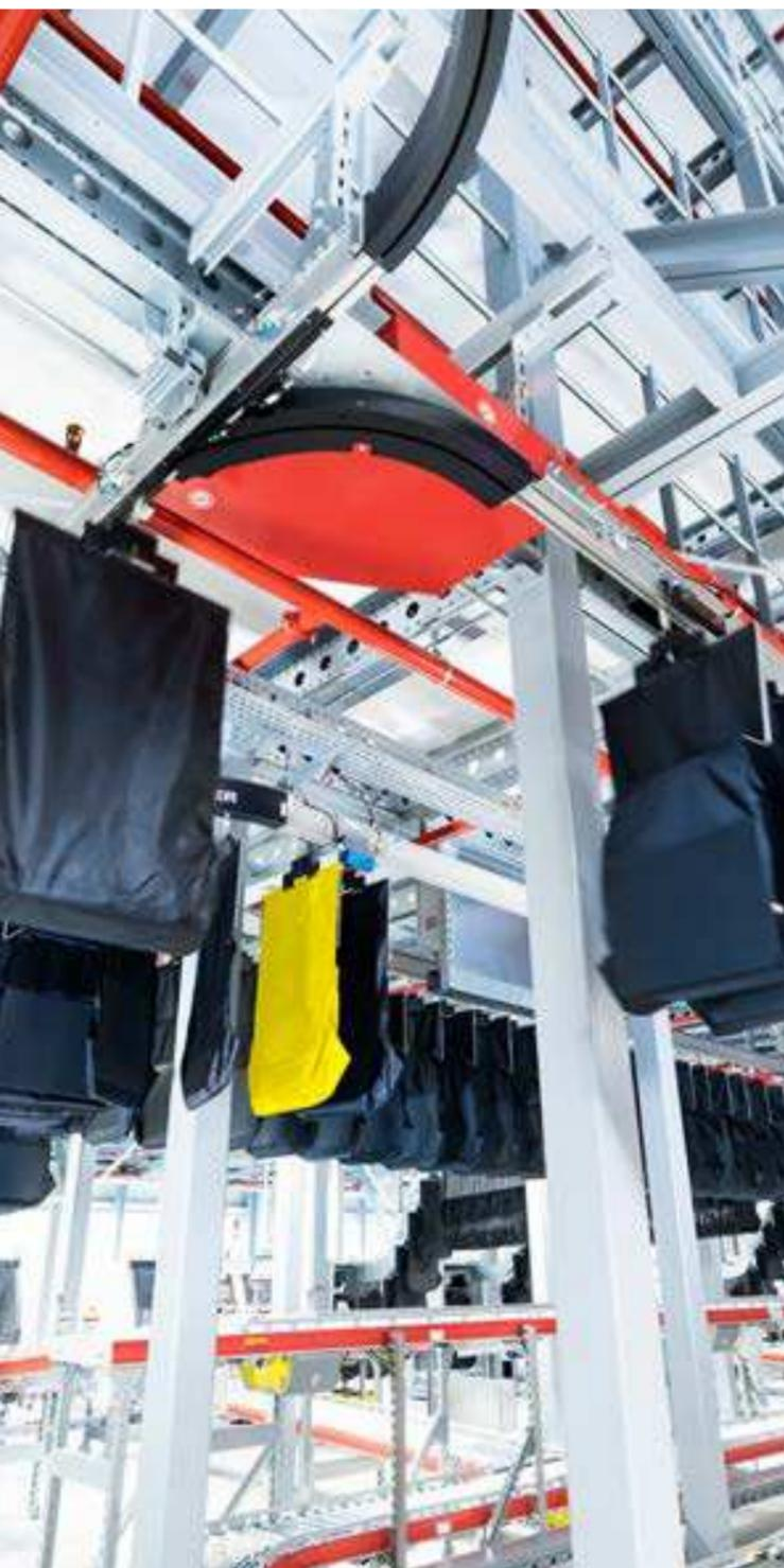
Le cœur du système est l'innovant pocket sorter SSI Carrier de SSI SCHÄFER. Ce convoyeur aérien, de conception modulaire permet un transport flexible et en douceur de marchandises plates et suspendues. Il peut traiter très efficacement n'importe quelle combinaison de petites commandes typiques du e-commerce, ainsi que les commandes plus importantes du commerce de détail.
