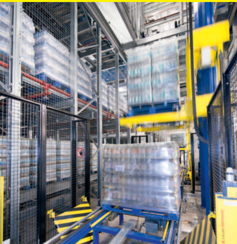
Bild oben: Die Ein- und Auslagerungen übernimmt das Kanalfahrzeug Schäfer Orbiter System (SOS)
