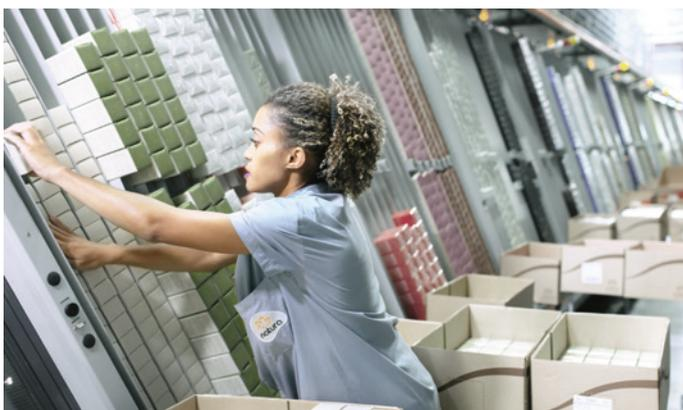
Der A-Frame von SSI SCHÄFER führt komplexe Auftragszusammenstellungen vollautomatisch, zuverlässig und innerhalb kürzester Zeit aus. Er eignet sich speziell dafür, kleinste Verpackungseinheiten sicher und fehlerfrei zu kommissionieren. Der Durchsatz von Schnell- und Mitteldrehern kann dank eines ausgefeilten Systems mit geraden und geneigten Produktkanälen – je nach Modell – enorm gesteigert werden.
