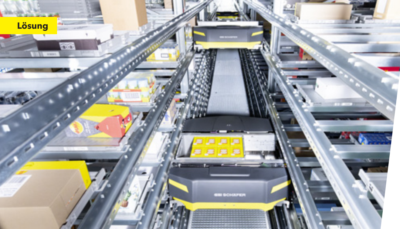
Ein- und Auslagerung durch SSI Flexi-Shuttles
