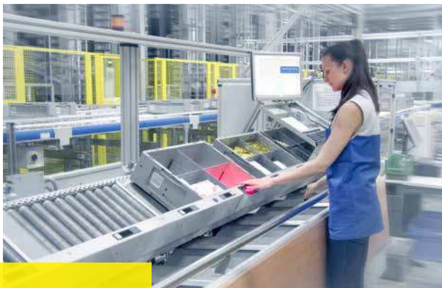
Poste de travail Pick to Tote
