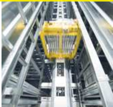
45 ascensores conectan con los diferentes niveles en el área de almacenamiento de la Navette
