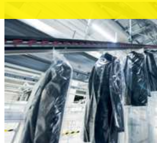
Pin conveyor para el transporte automatizado entre distri
