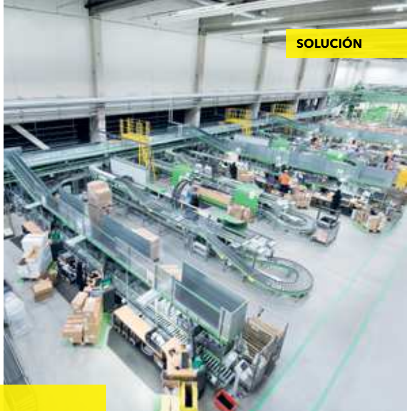
Puestos de reempaquetado y recogida
