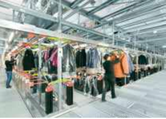
Batch Kommissionierung mit RF-Terminals
