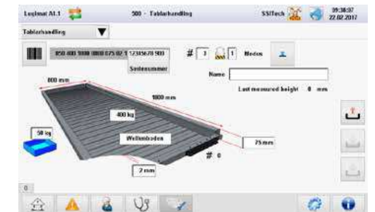
Visuelle Darstellung des Gerätestatus. Die Funktionen werden sprachunabhängig und intuitiv mittels Icons dargestellt.
