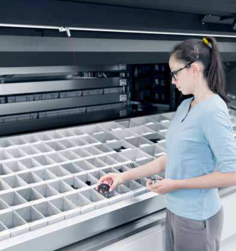
LogiTilt: Neigungsvorrichtung des Tablars zur ergonomischen Bedienung
