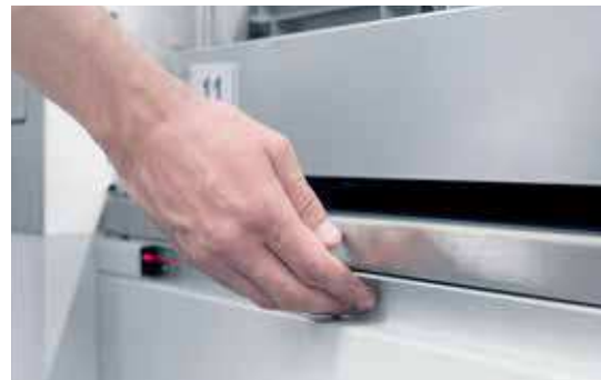
LogiBar: Durchgehende Bestätigunglichtschranke unter der Bedienöffnung zur Optimierung der Kommissionierleistung
