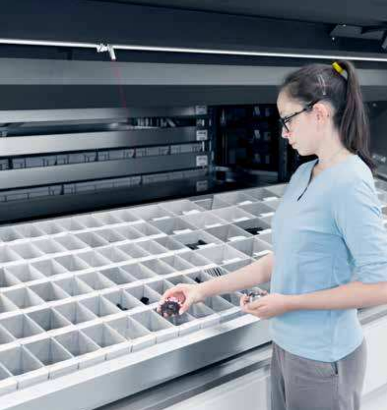
LogiTilt: Meccanismo di inclinazione del vassoio che consente un prelievo ergonomico
