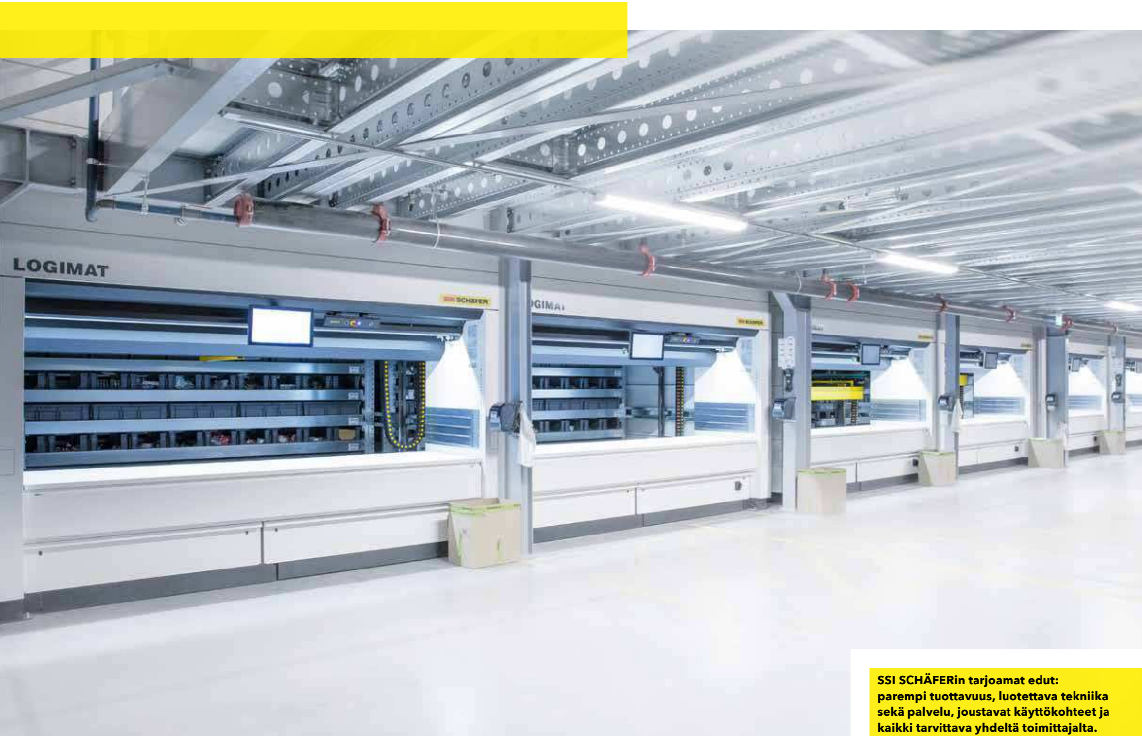
Varastoautomaatin käyttöaukko sijaitsee varaston lattiatasolla, jolloin itse varastoautomaatti voidaan rakentaa kellarista kattoon.
