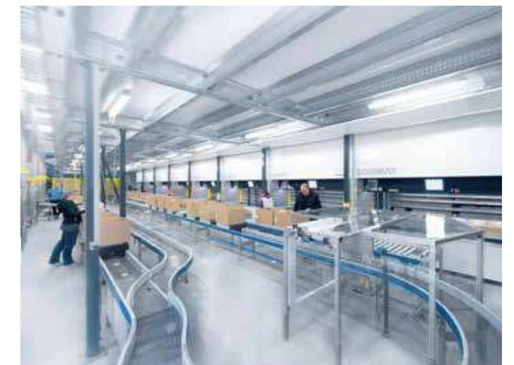
Useita LOGIMAT-varastoautomaatteja voidaan käyttää varastonimikkeiden keräilyyn ja varastointiin yhtä aikaa, jolloin saavutetaan suuri keruutehokkuus ja ryhmäkeruun edut.
