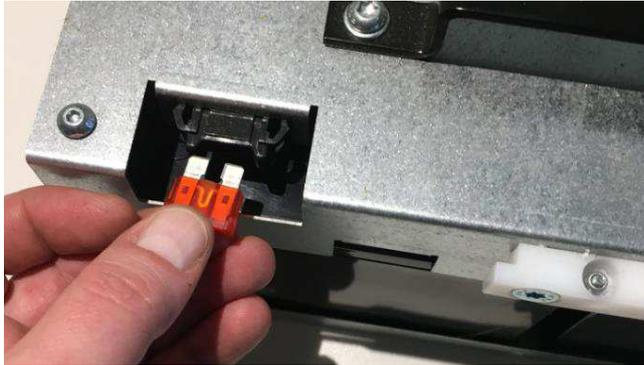
Abb. 12 | Einsetzen der Schmelzsicherung
