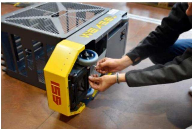
Abb. 11 | Entfernung der Transportsicherung
